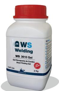
Gel decapante de color rojo para aplicar con pincel. Elimina de los cordones de soldadura el ennegrecimiento de las zonas afectadas por el calor del arco eléctrico, así como las manchas de óxidos en aceros inoxidables y sus aleaciones. Deja un acabado uniforme y un aspecto satinado brillante. Elimina todos los signos potenciales de corrosión ferrítica, óxido externo, las capas de cromo reducido y abrasiones.
