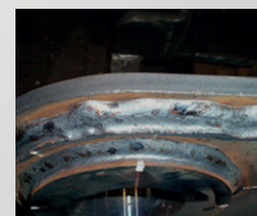
Ejemplo de mal posicionado del hilo
