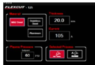
– Gestión del proceso: todos los parámetros se controlan desde la interfaz en función de la simple elección del material y el grosor, lo que simplifica la aplicación del corte por plasma. Varias funciones aumentan la productividad del ciclo y compensan automáticamente el desgaste de los consumibles.
