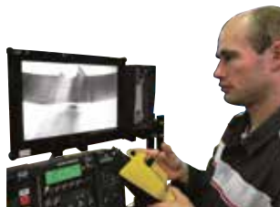
Sistema con gran pantalla a color de 15", cámara miniaturizada e iluminación adicional
