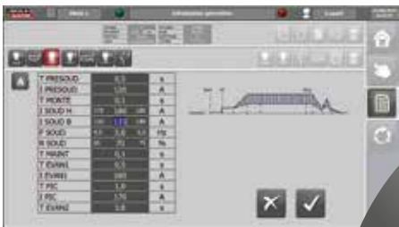
Visualización clara del ciclo de soldadura y parámetros relacionados
