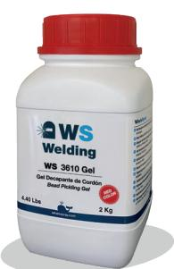
Gel decapante de color rojo para aplicar con pincel. Elimina de los cordones de soldadura el ennegrecimiento de las zonas afectadas por el calor del arco eléctrico, así como las manchas de óxidos en aceros inoxidables y sus aleaciones. Deja un acabado uniforme y un aspecto satinado brillante. Elimina todos los signos potenciales de corrosión ferrítica, óxido externo, las capas de cromo reducido y abrasiones.
